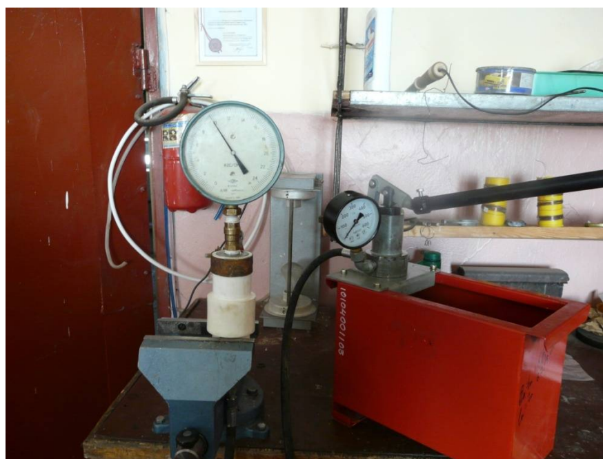
Рисунок 4.7 - Общий вид станда для гидравлических испытаний труб и сварных соединений
