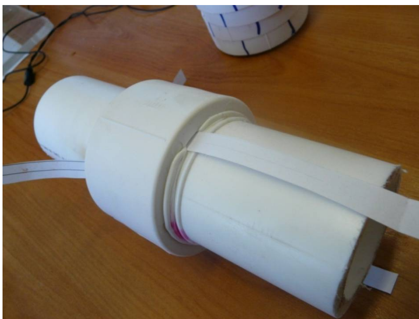
Рисунок 4.6- Раструбное сварное соединение с заданным дефектом в виде непровара
